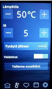
Wählen Sie die Temperatur (40-60 °C) und das Programm für die IR-Paneele aus.
